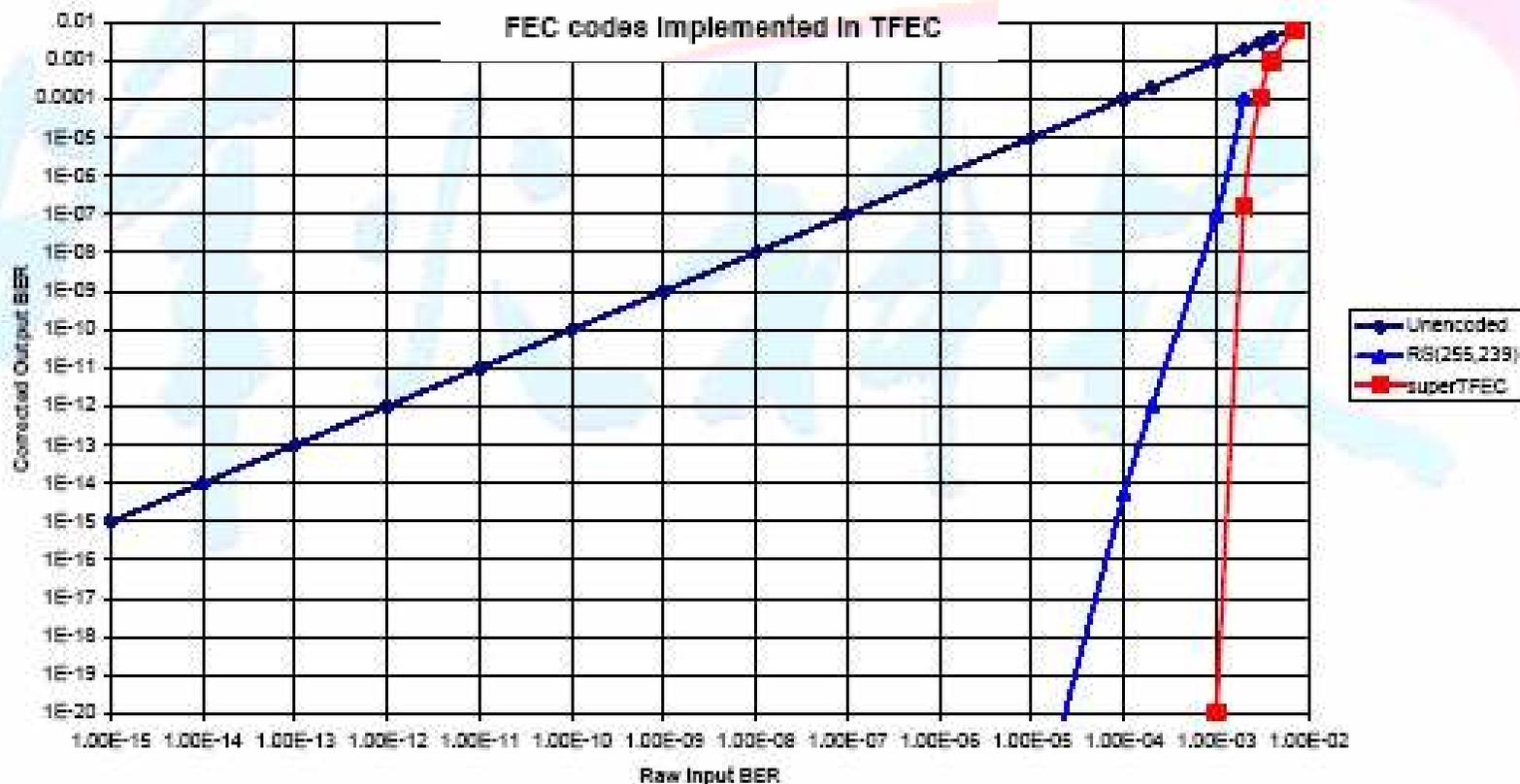
注意图中，只需要线路传输能保证 $3.5 \times 10^{-4}$ 就可以满足FEC解码后 $1 \times 10^{-12}$ 的BER要求；如果采用超强FEC，则只需要 $2.5 \times 10^{-3}$ 就可满足FEC解码后 $1 \times 10^{-12}$ 的BER要求。
